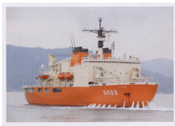
融雪用散水装置による散水 (海上自衛隊広報誌より抜粋)
