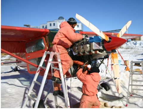
野外でセスナ機のエンジンを交換する航空隊員。45 次隊で固定翼機の使用は最後となる。航空機関連の建物はついに一度も建設されなかった。
